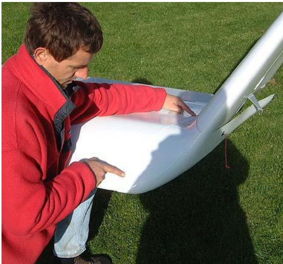
15. ... en progressant depuis le repère vers le bord d'attaque et le bord de fuite.
