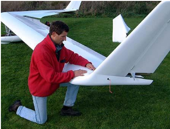
13. Appuyer l'intrados de l'aile sur un genou. Aligner le turbulateur d'extrados avec le repère correspondant sur le karman.
