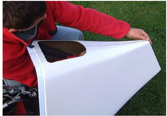
59. Achever la liaison des demi-cônes par l'arête supérieure.
