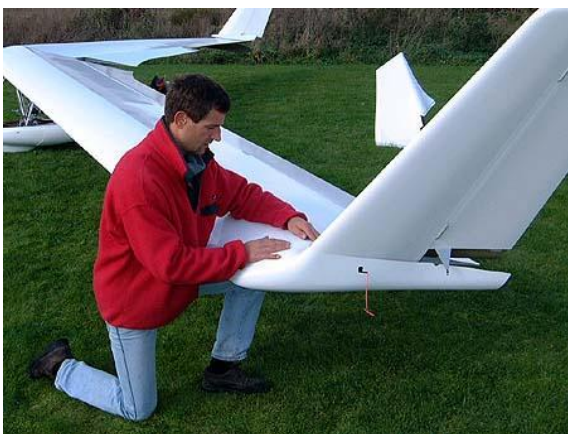
37. Appuyer l'intrados de l'aile sur un genou. Aligner le turbulateur d'extrados avec le repère correspondant sur le karman.
