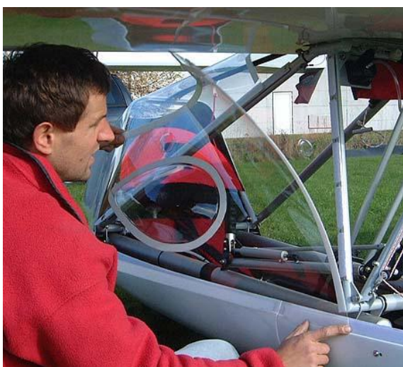
66. Présenter la fenêtre latérale en commençant par son angle avant. Positionner l'angle pour qu'il soit dans le prolongement du tube latéral.
