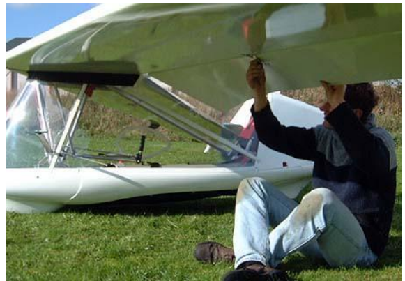
79. Brancher les commandes de flaps (la commande doit être réglée entre 0° et 15 ° pour que la connexion soit aisée).
