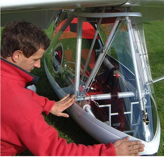
76. Repasser le long du carénage et serrer fermement les velcro.
