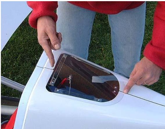
60. Mettre en place la fenêtre de parachute rangée sous l'appui-tête. Verrouiller le support de parachute.
