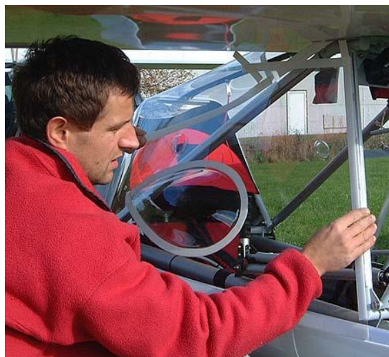
67. Suivre l'arête verticale et engager les velcro.
