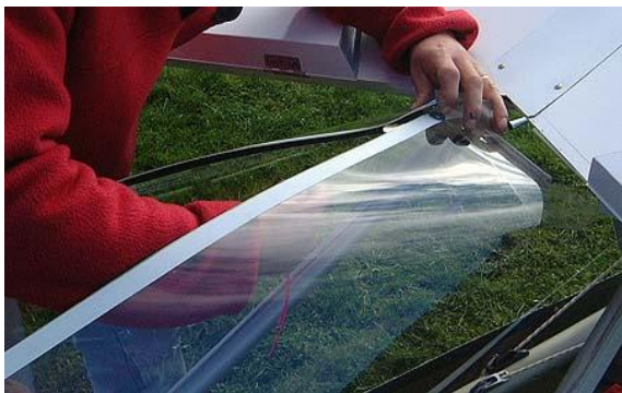
64. Procéder de même avec la fenêtre arrière gauche puis engager et fermer le zip.
