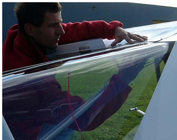
65. Mettre en place les rabats des vitres sur le bord de fuite des ailes de manière à ce que les vitres soient dans le prolongement de l'extrados.
