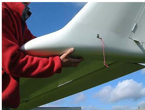
40. Progresser ensuite simultanément sur l'intrados en continuant de progresser sur l'extrados.
