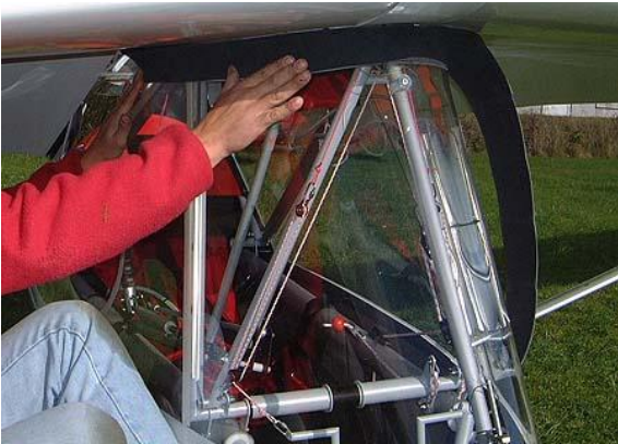
78. Engager les velcros en progressant depuis le tube avant en s'alignant sur le velcro des fenêtres.
