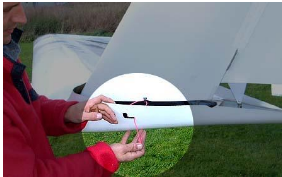
36. Présenter le karman de winglet. Passer le câble de commande à travers l'ouverture prévue.
