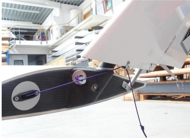
Présenter le karman, passer le câble de commande à travers l'ouverture puis mettre le karman en position sur ses aimants. Le karman doit être engagé dans le crochet extérieur.
