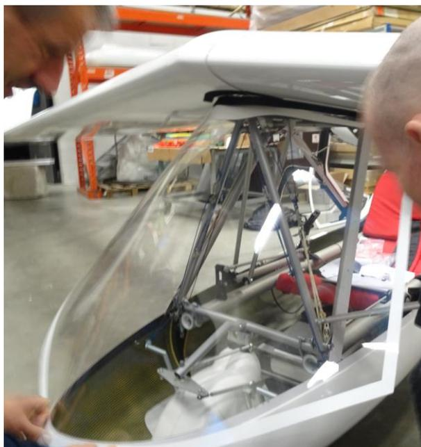
Suivre la ligne du fuselage puis l'alignement des rivets des montants.
