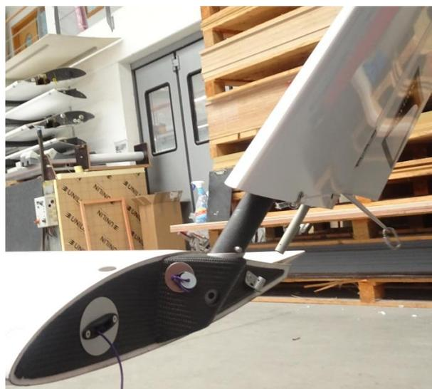
Passer le câble de commande à travers le pontet, mais ne pas le raccorder à ce stade.
