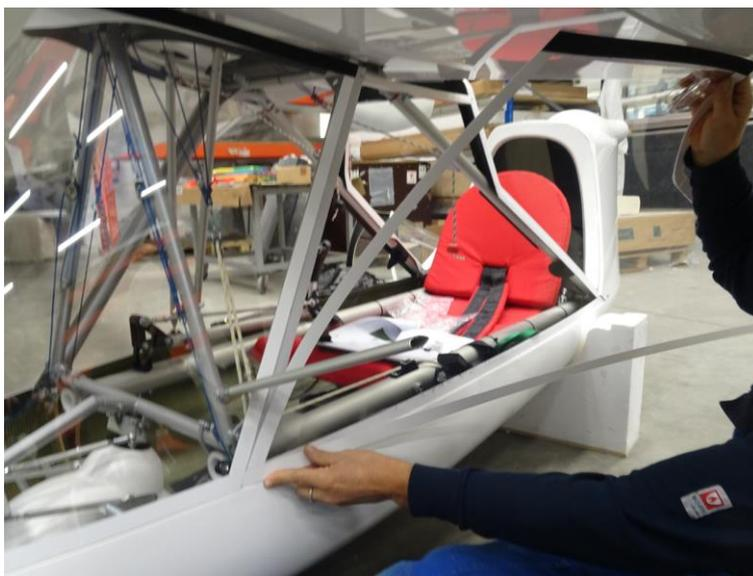
Suivre le bord du parebrise sur le montant et la ligne du fuselage.
