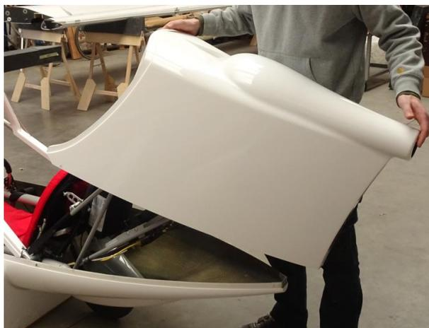
Faire passer le feutre anti-bruit devant le parachute, basculer le capot et veiller à l'engagement du pion de fixation arrière.
