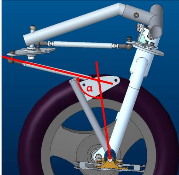
Eviter les réglages qui donnent un angle trop plat (= trop proche de 180°) entre les palonniers de direction et les bielles correspondantes, car dans ce cas une pression un peu forte sur la pédale engendre des efforts importants dans la cinématique pouvant déformer le guignol inverseur de direction et mener à l'inversion de la cinématique.
