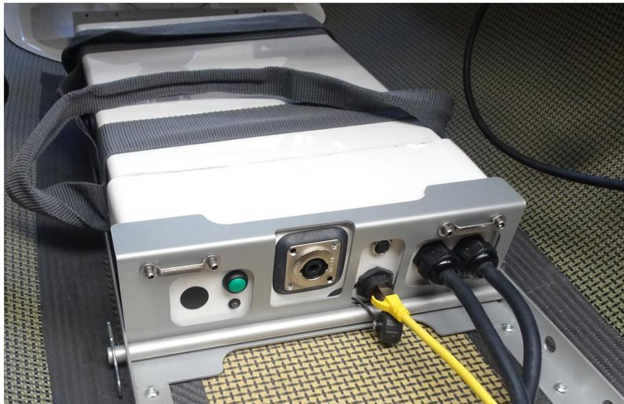
Installer la plaque de fixation avant et engager le tube de verrouillage d'un côté puis de l'autre. Verrouiller le tube avec les 2 goupilles beta.
