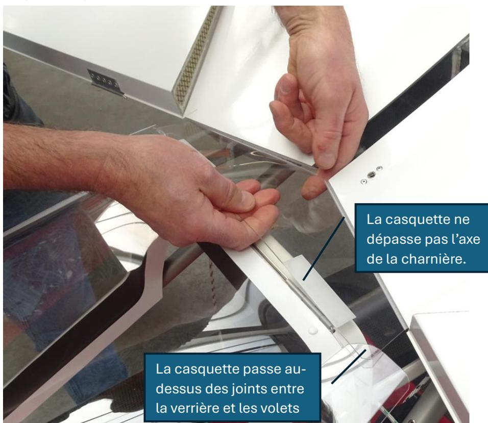
Veiller à ce que la casquette soit bien centrées sur la jonction des ailes, qu'elle ne dépasse pas l'axe des charnières (pour permettre l'ouverture de la verrière) et passe au-dessus des joints entre la verrière et les volets.
