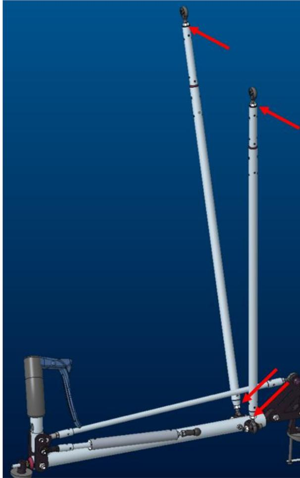
**La vitesse manche lâché** pour une position donnée des volets (flaps) peut être ajustée en jouant sur la rotule du compensateur, en vissant ou dévissant cette rotule. La rotule peut être libérée en déclinçant le fermoir en plastique de la rotule.
