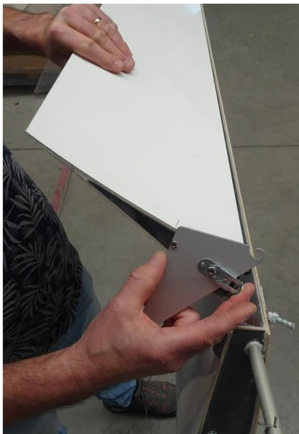
Présenter le winglet sur son support, enfoncer la bille et glisser le winglet sur ses supports jusqu'au verrouillage par la bille. Installer la goupille beta sur le support arrière.
