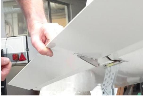
Remarque : il est préférable de connecter les volets (flaps) sur leur bielle en fin de montage pour faciliter l'accès à la cellule.
