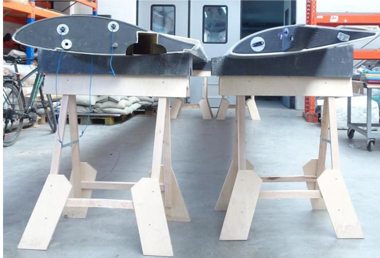
Lors d'un stockage prolongé au-delà de quelques jours, il convient de relâcher les 2 élastiques de rappels des volets (flaps), même si les bielles de volets sont sorties. Ceci pour éviter des tensions inutiles sur les intrados des ailes qui pourraient les déformer à la longue. Voir le chapitre consacré au montage.
