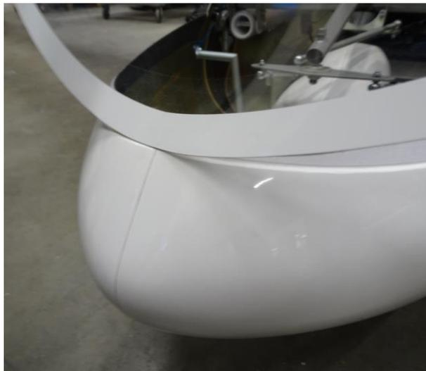
Appuyer le dessus du parebrise sur le support en le repliant vers l'arrière du fuselage.
