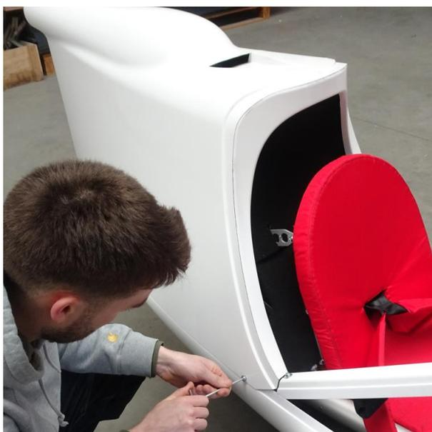
Remarque : Lors du démontage du capot moteur, ne pas dévisser la vis du pion, à l'arrière du capot !
