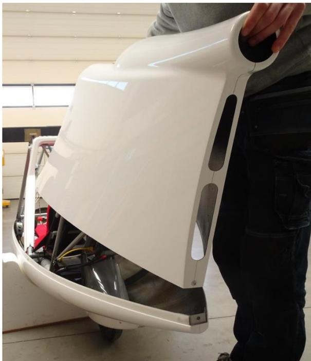
Installer les 2 vis de fixation du capot.
