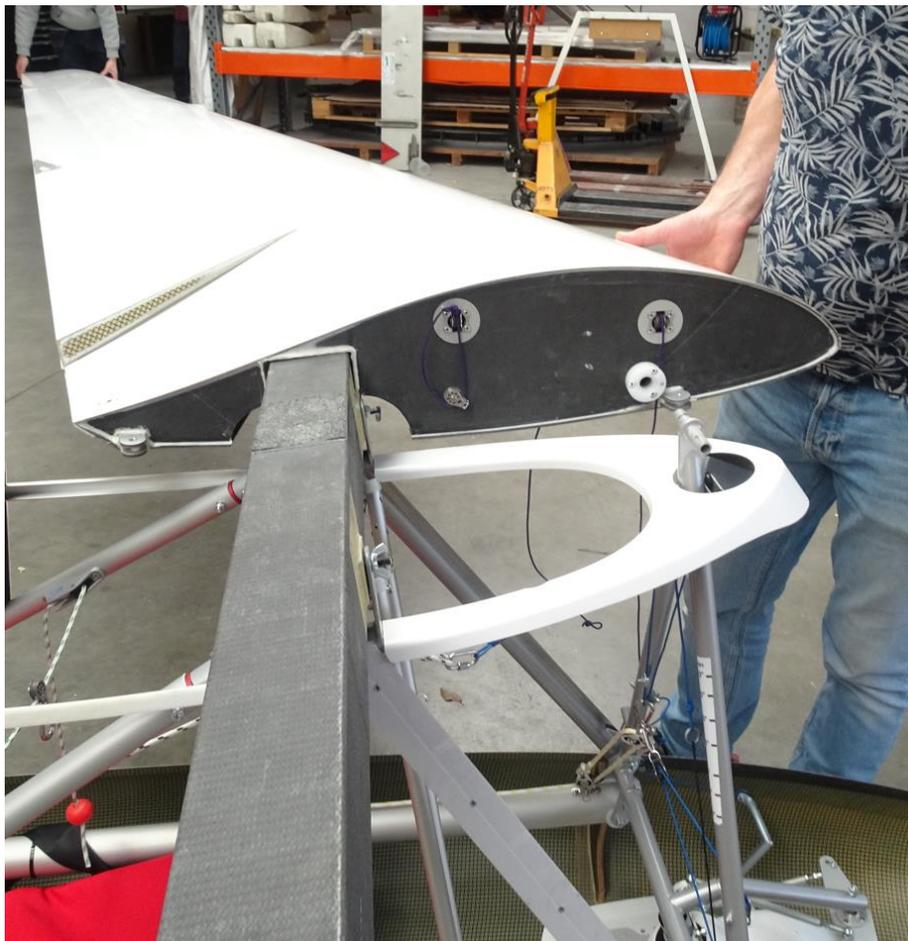
Glisser le fourreau de l'aile sur le longeronnet. **Veiller à ne pas forcer le fourreau du longeronnet** en alignant l'aile en hauteur, en flèche et en incidence.
